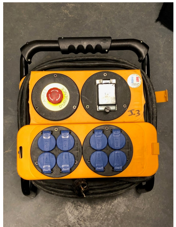
Coffret électrique 220 V, 16 ampères
